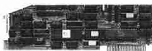
AP 14 Floppy-Controller für alle Anwendungsfälle. 10 Laufwerke können gleichzeitig angeschlossen werden. 4 x 8" DSDD, 4 x 5 1/4" DSDD und zwei Apple-Standardlaufwerke. Maximal ca. 10MByte im Direktzugriff. Bestell-Nr.: A 1014
