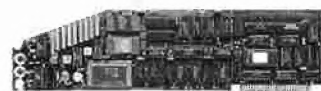
AP 19 12-Kanal AD-DA-Wandler mit 12 bit Auflösung und 25 \mu sec Wandlungszeit. Eingangsspannung \pm 10 V. Ein schneller Wandler für extrem schnelle Anwendungen. Bestell-Nr.: A 1019
